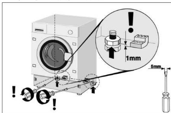
電器放置到位後，需調高後部踢腳這樣就可以抽出滑動墊木了。後部踢腳調整完畢後，將電器放平，根據相應的高度固定前部踢腳。
