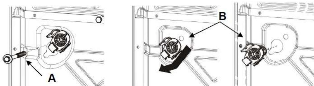
4. 將提供的所有塞子安裝好，以避免水濺到機器內部並接觸到帶電的部件。
