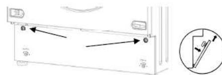
獨立式型號—將一個小的起子插入底座前部的縫內，然後向上撬動起子釋放底座的頂部，向前輕輕傾斜底座，向上拉卸下底座。
