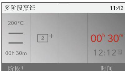
触摸两次显示屏选择步骤2和步骤3。触摸相应图标（步骤名称）确认或删除步骤。
