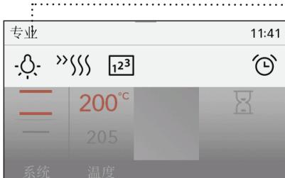
在额外设定中，触摸相应图标选择分步烹饪图标。
